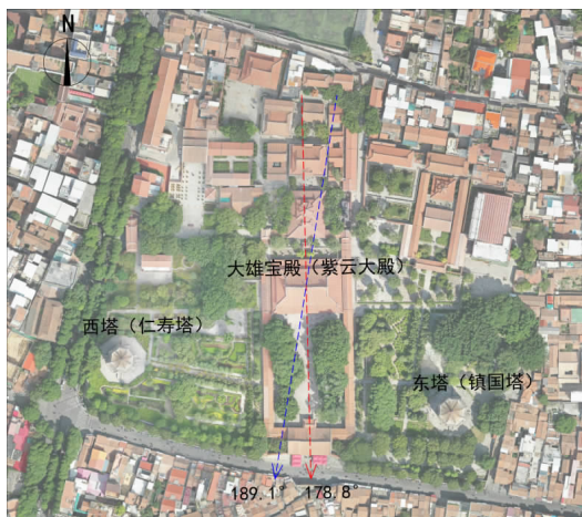
左 泉州开元寺大雄宝殿和殿塔缝针
